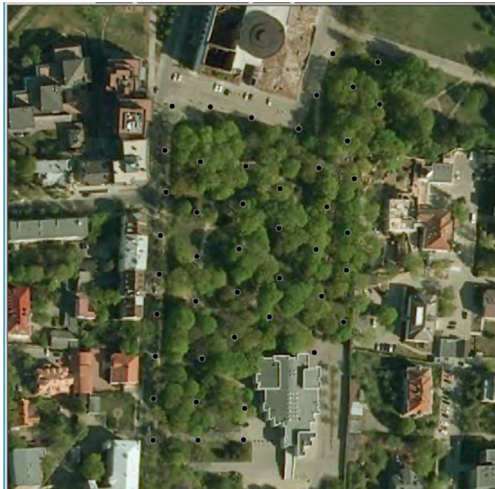
1 pav. 3D skenavimo taškų išsidėstymas Vilniaus evangelikų senųjų kapinių komplekse
