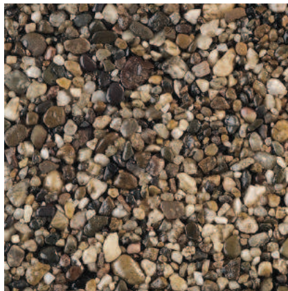
rišta žvirgždo skalda sustiprinta geotekstiline sistema, 0/11 frakcijos
